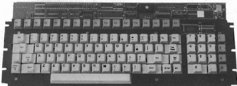
Tastiere G80 Cherry a basso profilo e tasti funzionali programmabili. Sono compatibili IBM, codici ASCII o IBM, uscite serie o parallelo, ed hanno tasti (MX) con contatti a barre d'oro incrociate.
